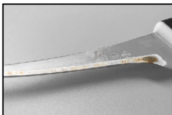
Fio queimado Burned wire | Hilo quemado
